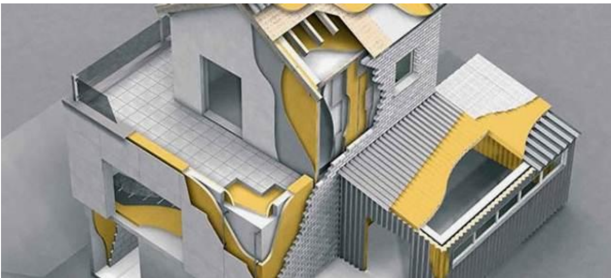
شکل (۱) عایق کاری ساختمان
