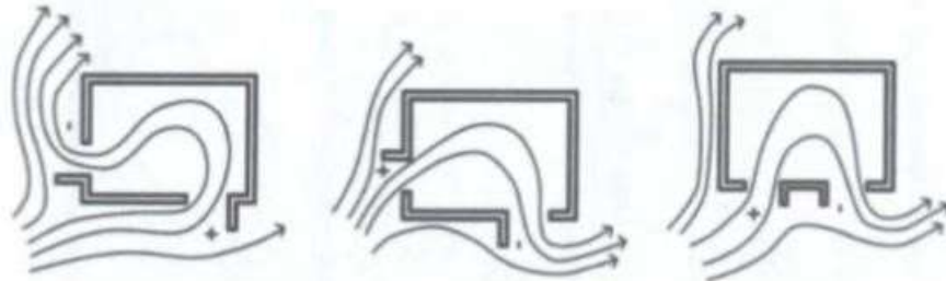
شکل شماره (۳): تاثیر دیواره های بازشوها و نحوه قرار گیری آنها نسبت به یکدیگر در حرکت جریان هوا
