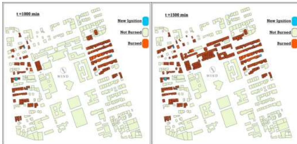
شکل شماره (7): نحوه گسترش حریق در مدل سازی انجام گرفته
