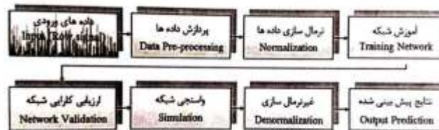
شکل (8): شمای کلی از روند مراحل مدل سازی به روش شبکه عصبی [14]
