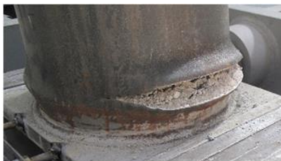
ب) کمانش و خرابی مدل آزمایشگاهی تحت بارگذاری
