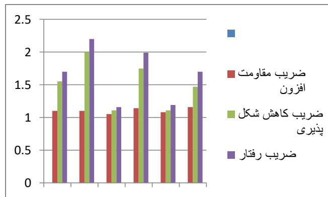
شکل (۲۱): نمودار رفتار لرزه‌ای سازه‌ها ۷ طبقه (فولاد St37 و فولاد St52) تحت زمین‌لرزه‌ها (بم، طبس و منجیل)
