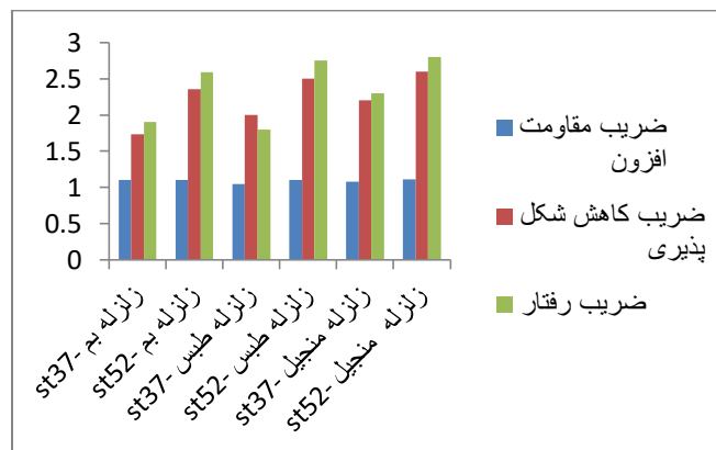
شکل (۲۲): نمودار رفتار لرزه‌ای سازه‌ها ۱۰ طبقه (فولاد St37 و فولاد St52) تحت زمین‌لرزه‌ها (بم، طبس و منجیل)
