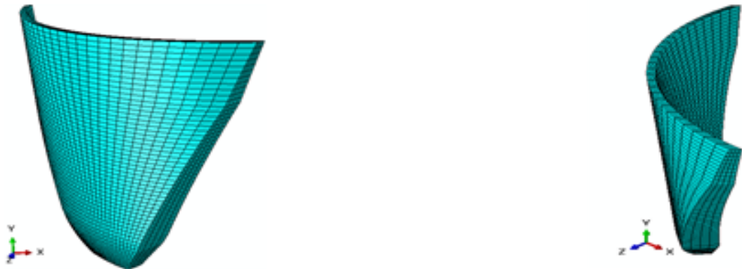
شکل ۶: مدل مش بندی شده سد دز در نرم افزار آباکوس
