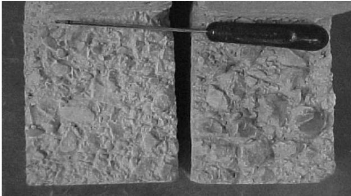
شکل شماره (۵): شکل سمت چپ بیانگر سطح تماس با زیری کم و شکل سمت راست بیانگر سطح تماس با زیری زیاد است
