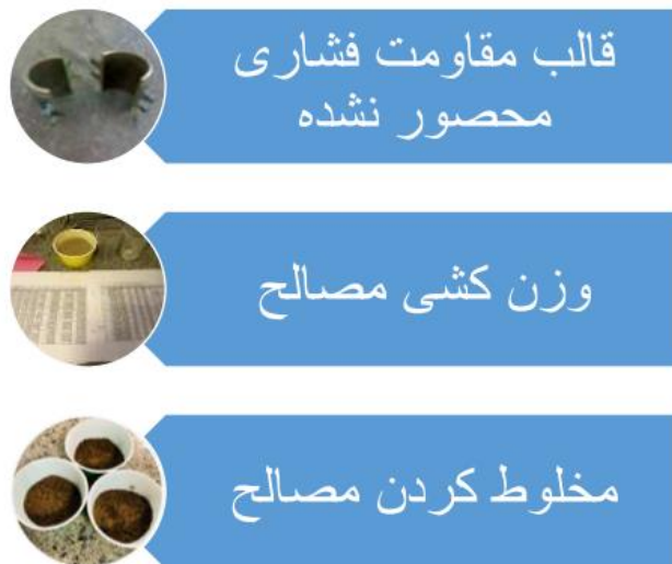
شکل (۱۲) مراحل نمونه سازی مقاومت فشاری محصور نشده
