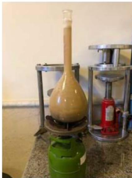
شکل (۴) آزمایش تعیین چگالی دانه های جامد
