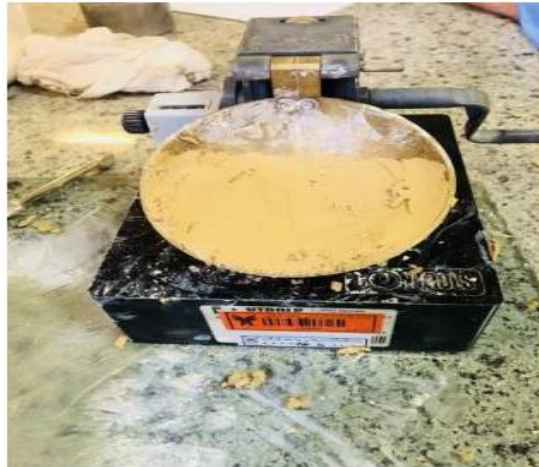
شکل (۳) آزمایش حدود اتربرگ
