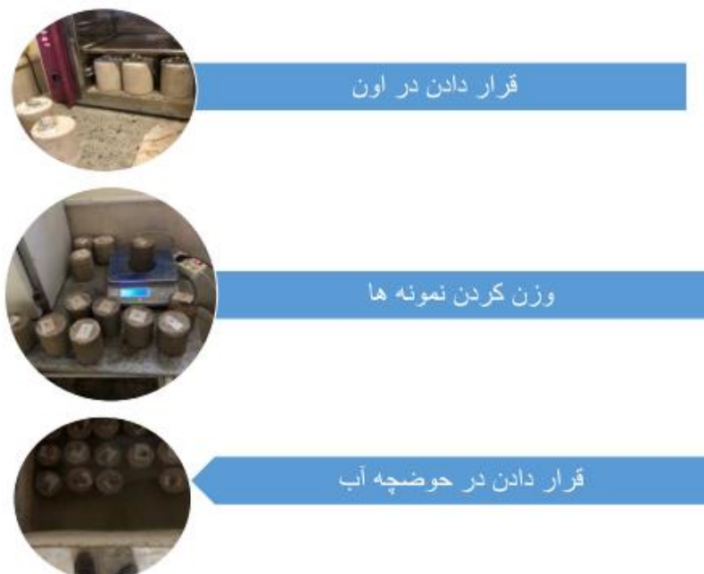
شکل (۱۶) مراحل انجام آزمایش دوام
