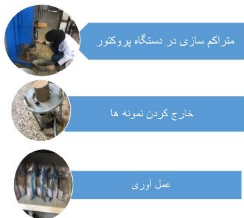
شکل (۱۵) مراحل انجام آزمایش تراکم
