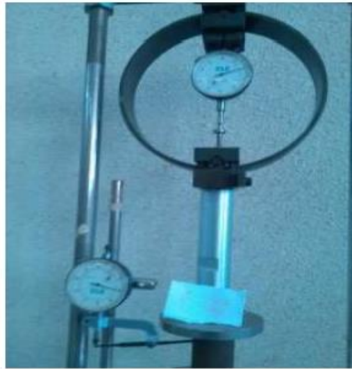
شکل (۱۳) نمایی از دستگاه مقاومت تک محوری به همراه گیج تغییر مکان و رینگ اعمال بار ۲ کیلونیوتن
