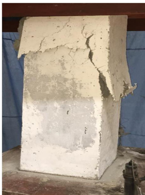
شکل شماره (۶): نحوه ترک خوردگی ستون CFT محاط در ECC [۱۷]
