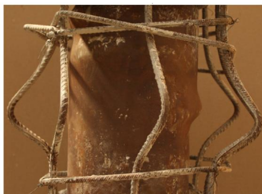
شکل شماره (۵): نحوه تغییر شکل آرماتوهای طولی و تیوب فولادی ستون CFT [۱۷]
