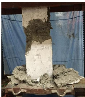
شکل شماره (۵): نحوه تغییر شکل آرماتوهای طولی و تیوب فولادی ستون CFT [۱۷]
