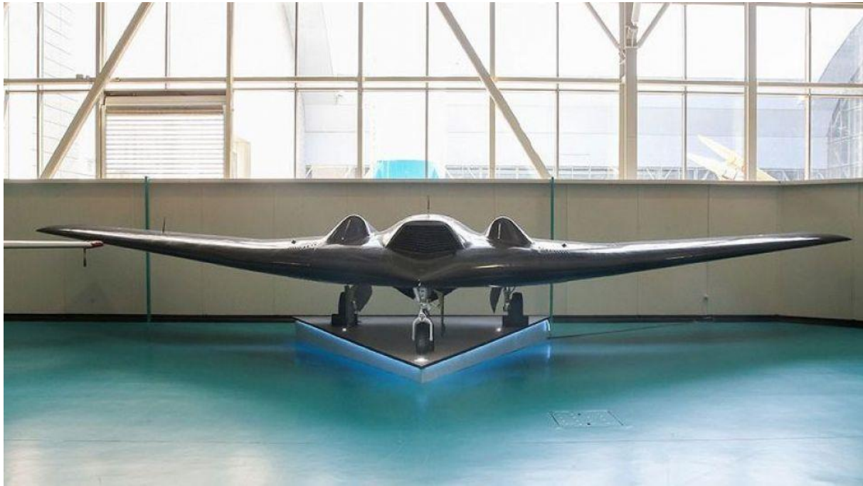
شکل ۳. پیکربندی تصویر C۲ (پهپاد سیمرغ نمونه خوبی برای این پیکربندی است).
