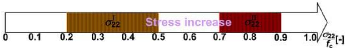
شکل ۲. محدوده سطوح تنش بحرانی \sigma_{22}^I و \sigma_{22}^II در بتن معمولی تحت عوامل مختلف مواد، تکنولوژی و خدمات (طبق [۹۵]).
